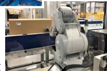
RFIDラベル 自動貼付システム
